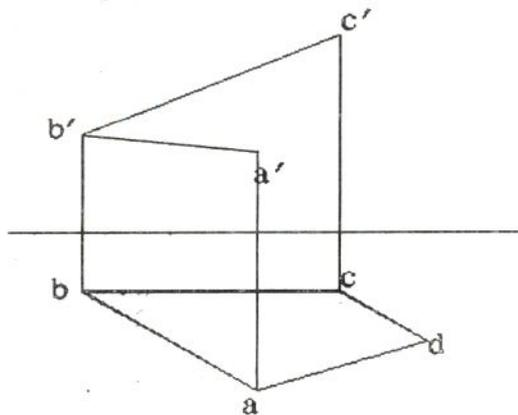
20. 已知 AB, CD 两直线相交于 K 点, 求 CD 直线的正面投影。
