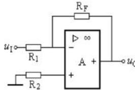
2.1 当输入电压  $u_1=0.5\text{ V}$  时, 输出电压  $u_o= ( )$ 。
